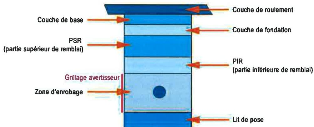
Pour les chaussées à faible trafic, les couches de fondation et de base peuvent être confondues.
