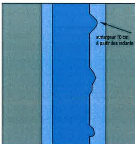
Concernant les surfaces à reprendre, la réfection intégrera la largeur de la tranchée et une sur largeur de 10 cm de part et d'autre en respectant une surface rectiligne (cf. croquis précédent), avec une couche d'accrochage. Les joints périphériques de tranchée seront traités à l'émulsion de bitume et sable par du matériau concassé 2/4, ceci afin de garantir l'étanchéité du revêtement de chaussée.
